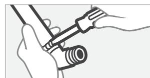
2. Schieben Sie das Rohrende bis zum Anschlag in das Anschlussstück, und ziehen Sie die Überwurfmutter fest.
