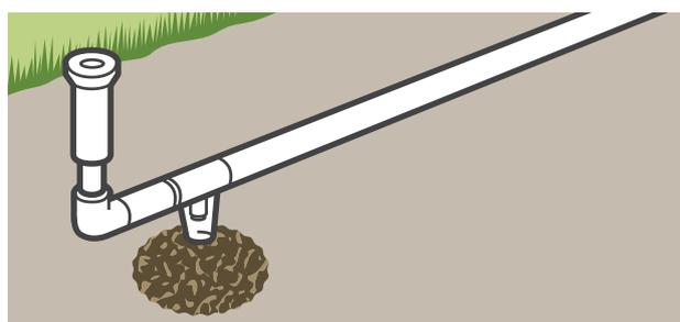
Bei Installation eines automatischen Entleerventils in Frostregionen: Positionieren Sie die Entleerventile am niedrigsten Punkt der jeweiligen Zone.
