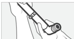
1. Schieben Sie die Überwurfmutter und den Ring über das Rohr.
